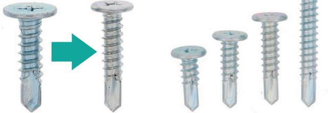
頭部高さは、1.2mmと低頭設定。鍋頭の基準寸法である2.6mmの半分以下の出っ張りで済みます。
